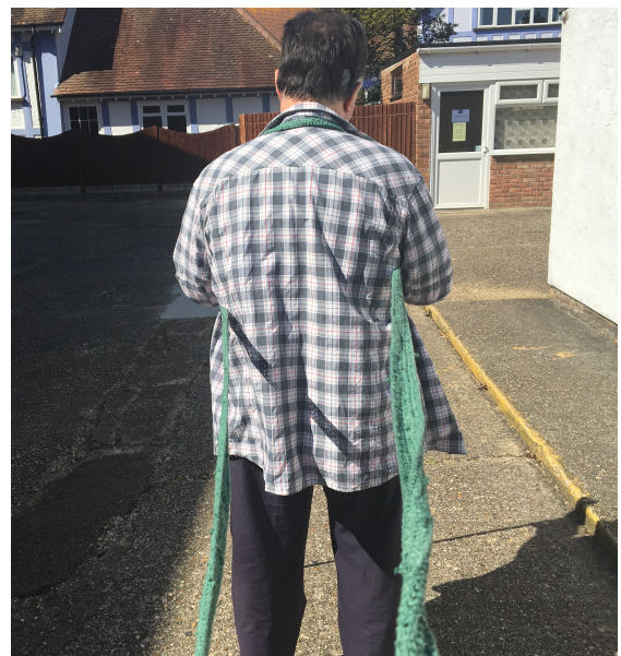
Kuvat 8 & 9. Vasemmalla virkattu haptinen ohjausvyö ja oikealla sen testaaminen ulkona. (Kuvat Lahtinen 2020)
