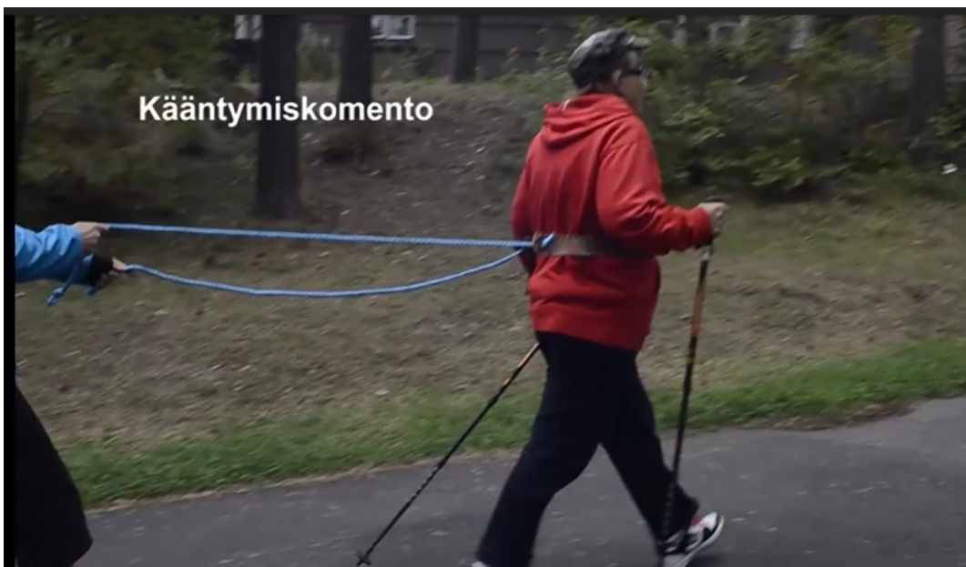
Kuva 3. Kääntymiskomento haptisen vyön kautta oikealle.
